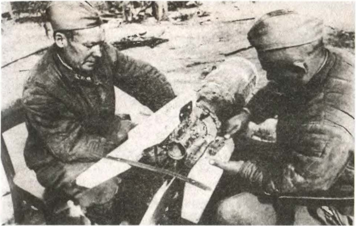
Установка деревянных стабилизаторов на «летающие торпеды»
